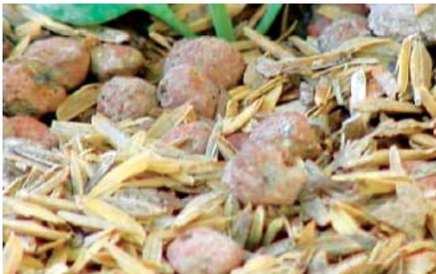
Fig. 7. Detalle de mezcla de alivén + cáscara de arroz + cáscara de maní
