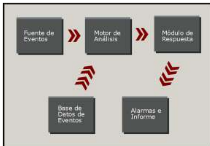
Figura 2.9 Estructura funcional básica del IDS.
