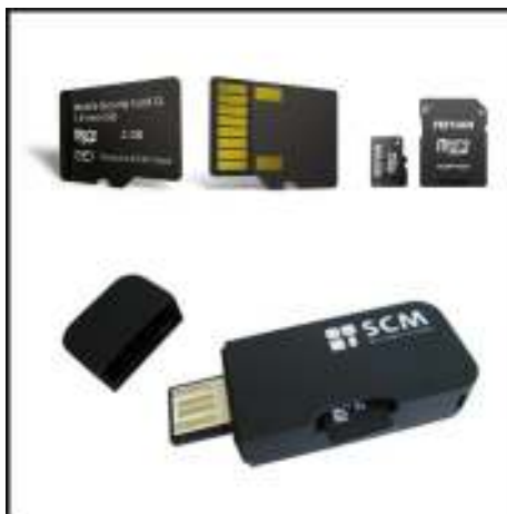
Figura 1.18 Token criptográfico en formato MicroSD y SD.
